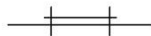
Rysunek 9. Łączenie taśmy samoszczepnej Velcro z materiałem za pomocą szwu łączącego zwykłego
