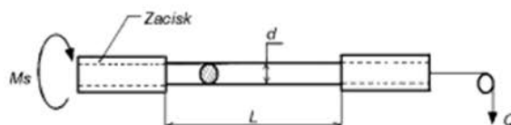
Schemat próby jednokierunkowego skręcania drutu
