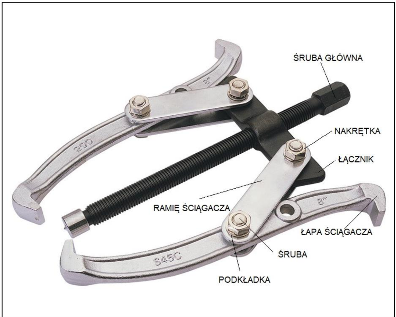
Rysunek 1. Ściągacz do łożysk
