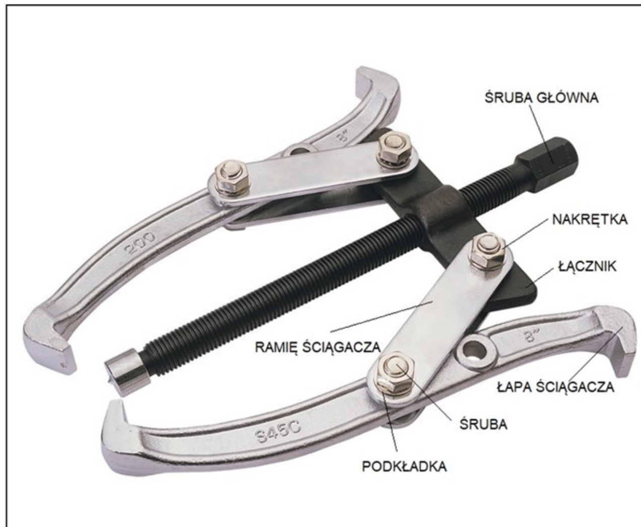
Rysunek. Ściągacz do łożysk
