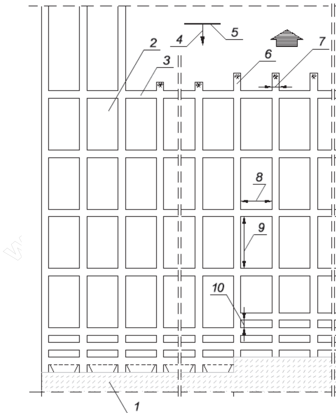
Rysunek 1. Schemat systemu komorowo-filarowego z podsadzką hydrauliczną
